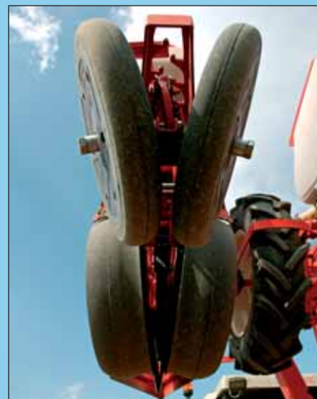
Na presnom uložení osiva sa podieľa aj výsevná trubica ústiaca na úrovni styku kopírovacích kotúčov s pôdou.
