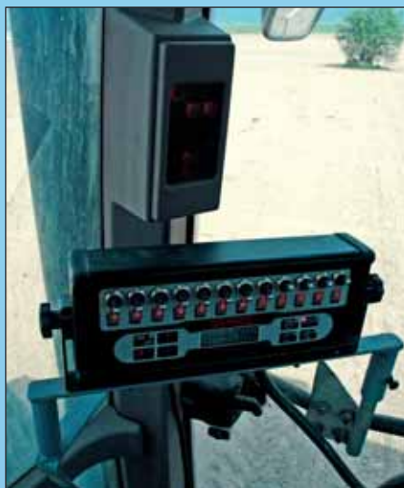
Počítač a kontrola vysievania pomocou diód boli presné.
